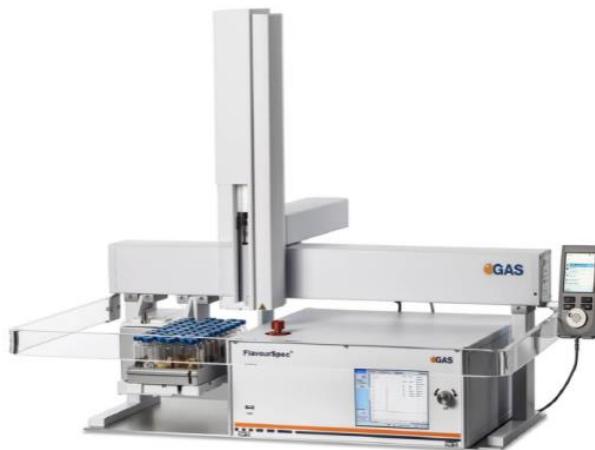
Figura 2.1. Echipamentul GC-IMS utilizat pentru analiza compușilor organici volatili (FlavourSpec®, G.A.S., Germania) cu sistem automat de injectare CTC-PAL 3.
