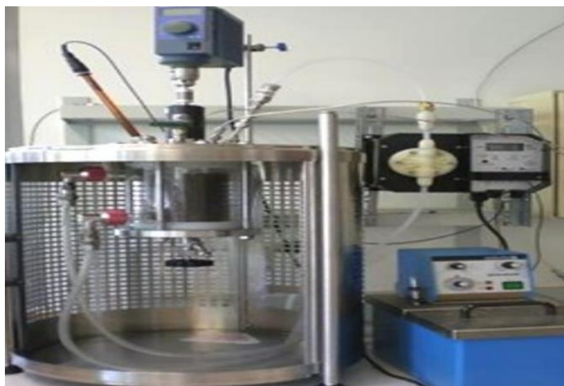
Figura 2.6 Instalația de măsurare experimentală a parametrilor procesului de fermentație anaerobă a tescovinei de struguri
