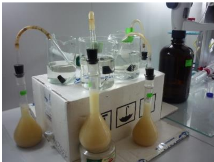
Figura 2.4 Instalația de laborator pentru studiul fermentației aerobe a biomasei în prezența SBA
