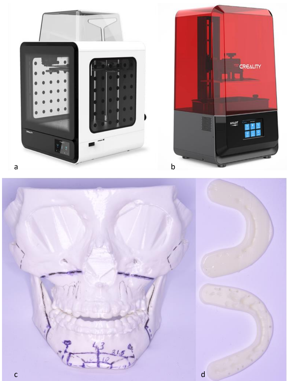
Figura 53. Imprimantele 3D utilizate în prezentul studiu. a) Imprimanta 3D FDM (modelare prin extrudare). b) Imprimanta 3D DLP (expunere digitală a luminii). c) Model anatomic obținut prin modelare prin extrudare. d) Splinturi ocluzale obținute prin expunerea digitală a luminii
