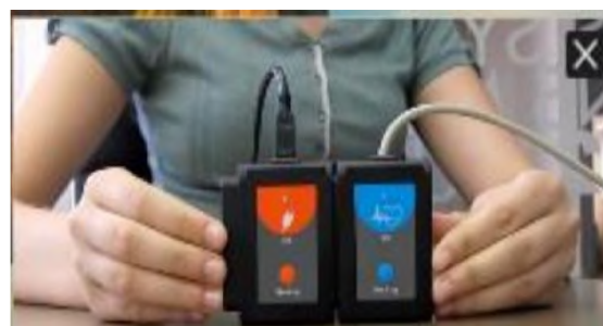
Fig. 2.23. Setarea senzorului NUL-218 prin conectarea modulului USB-200
