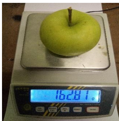
Figura 2.12. Determinarea gradului de deshidratare a țesuturilor prin cântărire
