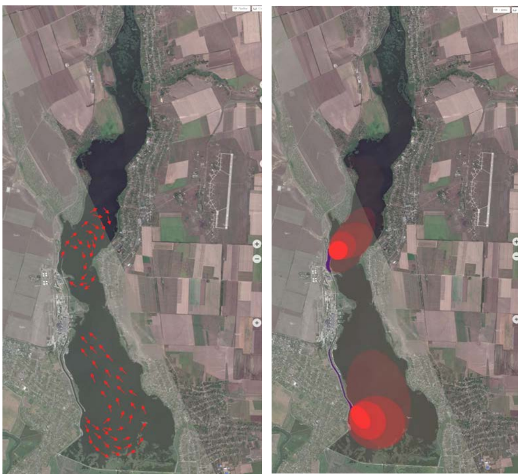
Рис. 1.4. Кольцевые течения и температурные поля Кучурганского водохранилища
