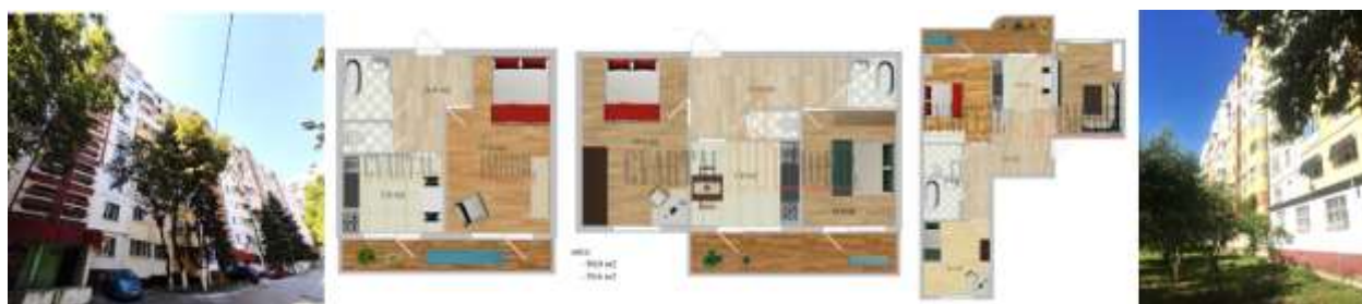
Figura 5.1. Blocuri de apartamente, seria Bălți din perioada RSSM și Republica Moldova. Apartament cu 1 odaie – 34 m 2 ; cu 2 odăi – 50 m 2 ; cu 3 odăi – 65 m 2 [533]
