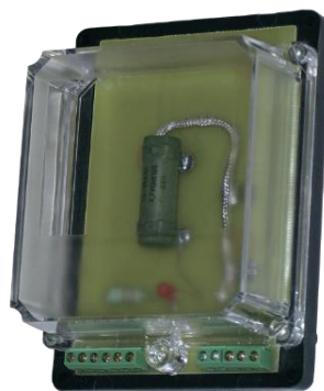
Figura 4.7. Aspectul emulatorului cuptorului ЭП10
