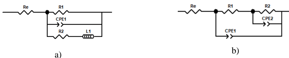
Fig. 3.5. Circuite echivalente folosite în modelarea spectrelor EIS a plăcilor de cupru ( S=2,5 \text{ cm}^2 ) în electrolitul pirofosfat în prezența oxigenului (a) și în absența lui (b)
