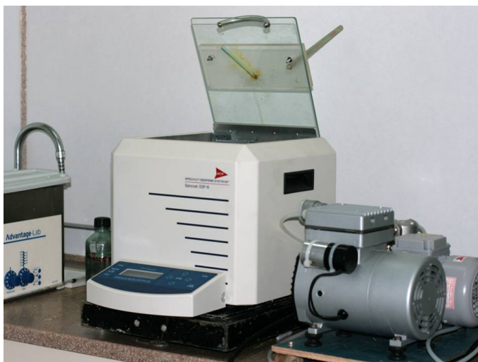
Рис. 2.10. Программируемая установка полива тонких слоев из раствора SCS Spincoat G3P-8.
