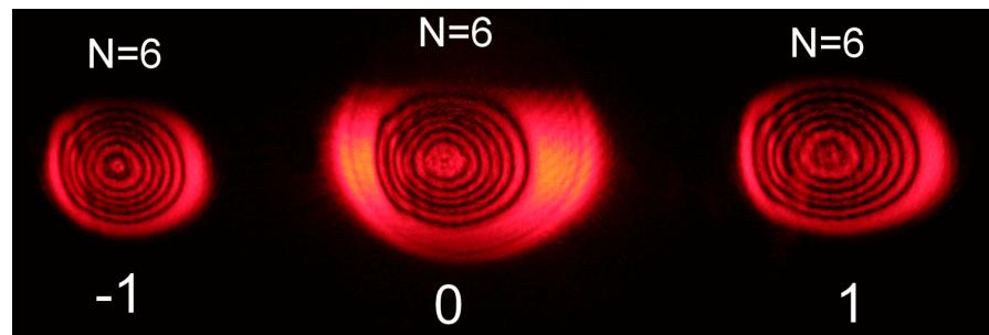
**Рис. 12. Дифракционная картина нулевого и первых порядков с наблюдаемыми кольцами в каждом порядке (по 6 колец) [29]**
