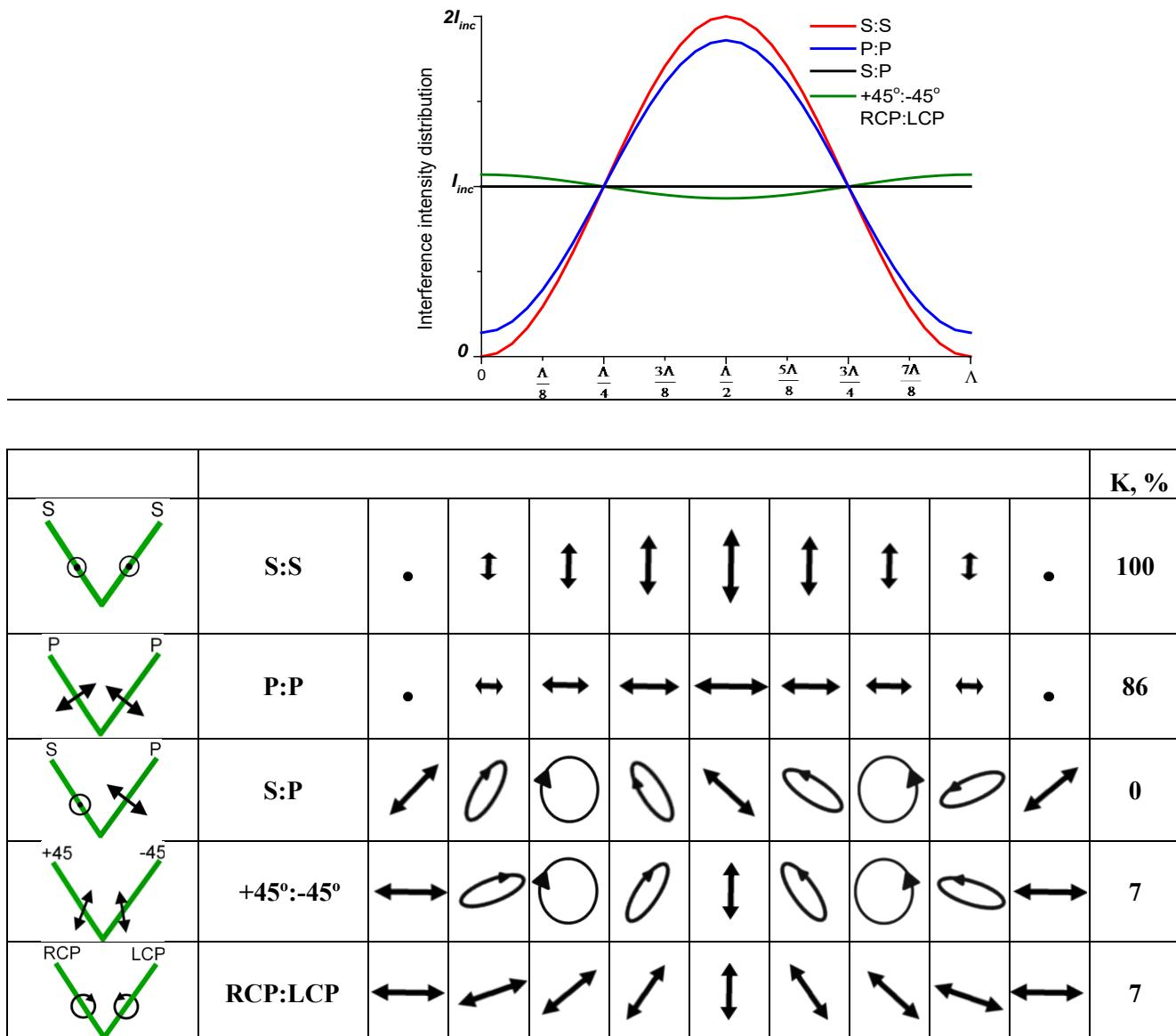
Рис. 14. Теоретический расчет интенсивности вектора электрического поля в пределах одного периода  $\Lambda=1$  мкм интерференционной картины.
