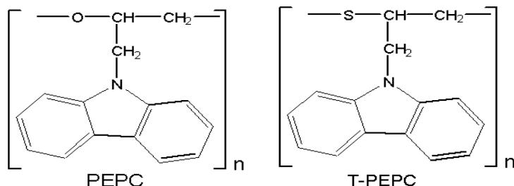
**Рис. 3. Химические структуры синтезированных полимеров полиэпоксипропилкарбазол (ПЭПК) и полиэпитиопропилкарбазол (ПЭТПК) [7].**
