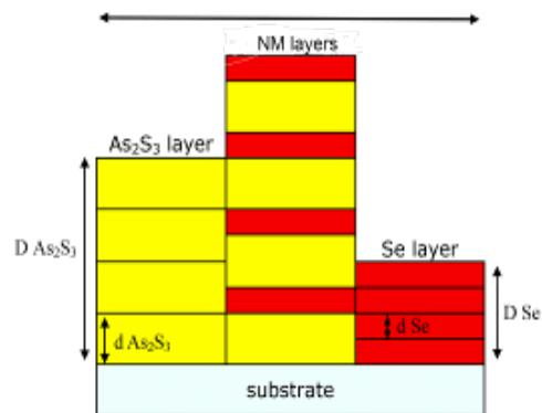
**Рис. 2. Поперечное сечение образца с 4 слоями As<sub>2</sub>S<sub>3</sub> и 4 слоями Se, D As<sub>2</sub>S<sub>3</sub> и D Se – общая толщина слоев As<sub>2</sub>S<sub>3</sub> и Se соответственно, d As<sub>2</sub>S<sub>3</sub> и d Se – толщина отдельного нанослоя As<sub>2</sub>S<sub>3</sub> и Se в многослойной структуре [6].**
