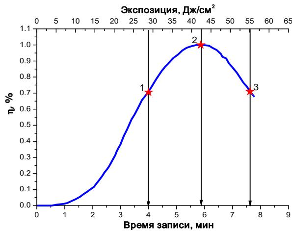
**Рис. 8. Кинетика изменения ДЭ решеток, записанных в слое As<sub>2</sub>S<sub>3</sub> с различными дозами: 1 – недо-экспонированная; 2 – нормально-экспонированная; 3 – переэкспонированная [23].**
