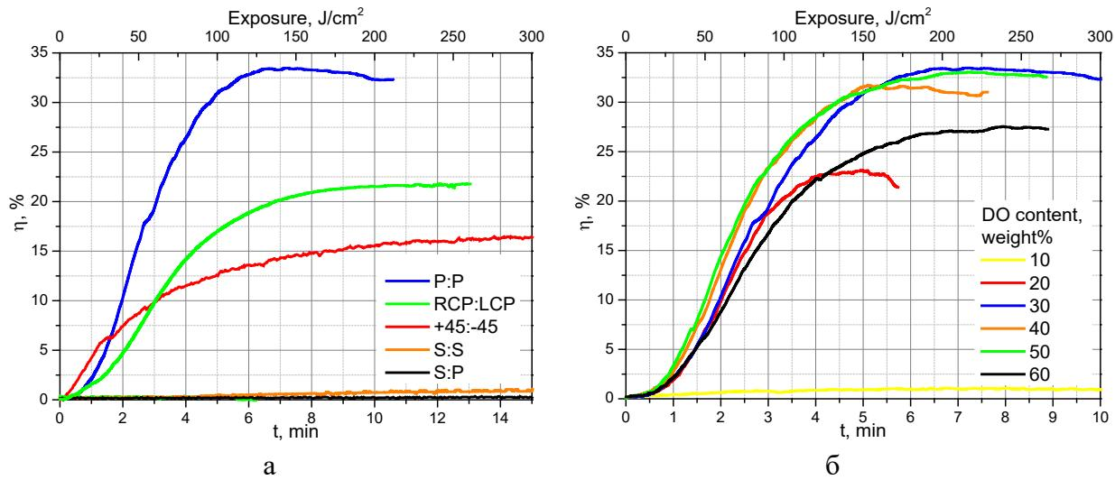
**Рис. 15. Зависимость дифракционной эффективности от времени записи для всех исследованных конфигураций поляризации (а) и при использовании поляризационной конфигурации Р:Р и концентрациях азокрасителя от 10 до 60 масс.% [32].**
