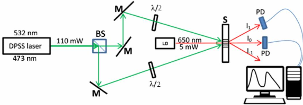
**Рис. 7. Голограммическая схема записи голограммических решеток.** DPSS laser – одномодовый (TEM<sub>00</sub>) твердотельный лазер с диодной накачкой, BS – поляризационный светоизделительный кубик, M – зеркала,  $\lambda/2$  – полуволновые фазовые пластинки, LD – лазерный диод, S – регистрирующая среда, PD – кремниевые фотодиоды [21].
