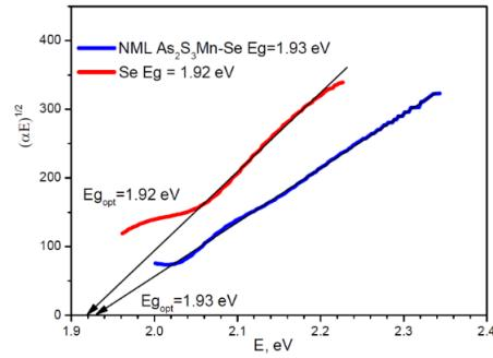
**Рис. 6. График зависимости  $(\alpha h\nu)^{1/2}$  от  $h\nu$  для многослойной структуры  $\text{As}_2\text{S}_3:\text{Mn-Se}$  и слоя Se [11].**
