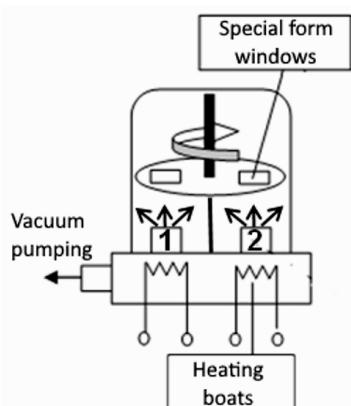
**Рис. 1. Приставка для нанесения многослойной структуры на основе XC с двумя испарителями: 1 - As<sub>2</sub>S<sub>3</sub> испаритель; 2 – Se испаритель [6].**
