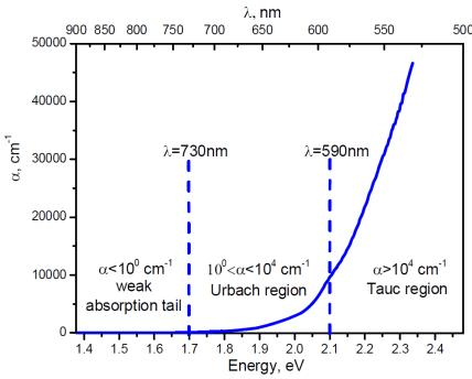
**Рис. 5. Спектр оптического поглощения  $\text{As}_2\text{S}_3:\text{Mn-Se}$  с тремя основными областями [11].**
