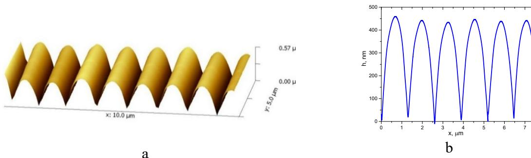
**Рис. 16. АСМ изображение (а) и поперечное сечение (б) поверхностной рельефной решетки, записанной на пленке ПЭПК-ДО (толщина 1600 нм, содержание азокрасителя 30 массовых %) в конфигурации поляризации Р:Р до значения ДЭ 30%, измеренной при 650 нм [32].**
