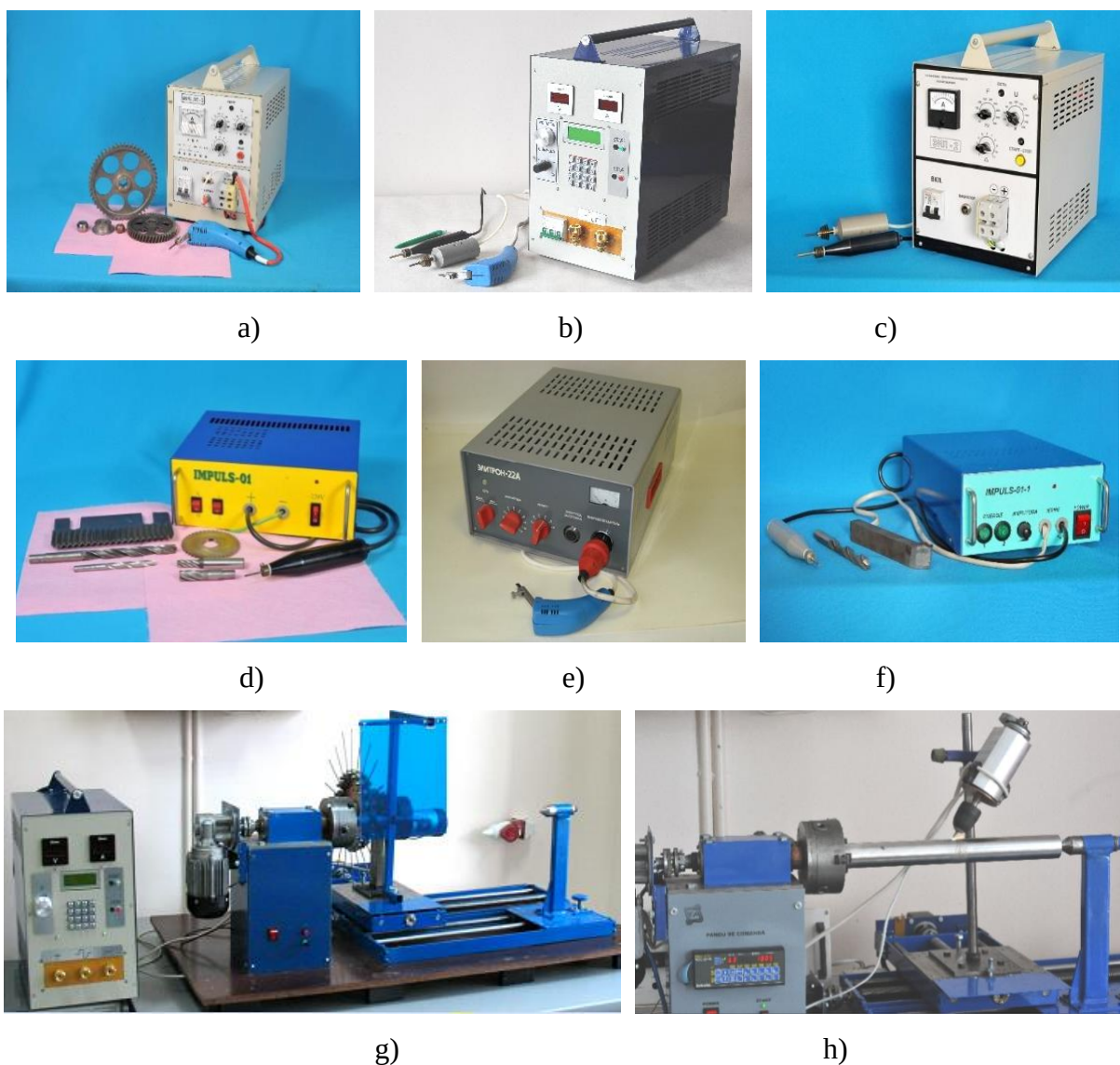
Fig. 2.1. Instalații tehnologice de aliere prin scânteii electrice: a), b), c), e) – instalații manuale industriale; d), f) – instalații manuale experimentale; g), h) – instalații experimentale cu comandă numerică
