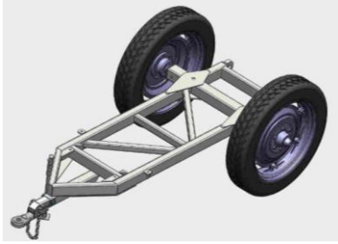
Fig. A4.2. Modulul-șasiu fără echipamentul de lucru
