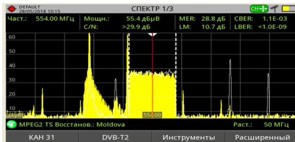
Fig. 3.5. Semnalul la ieșirea feeder-ului antenei R&S HL 040 orientate spre stația Strășeni (stația Strășeni – On, stația Hâncești – On)
