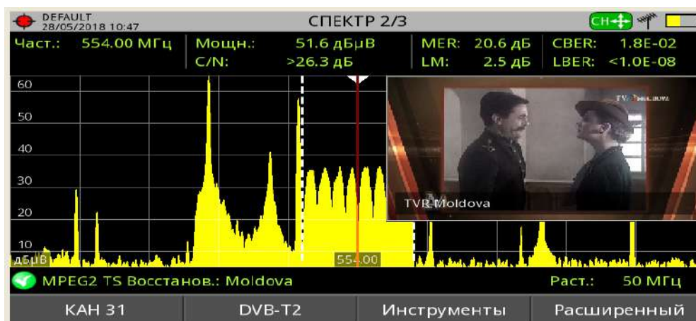
Fig. 3.6. Semnalul la ieșirea feeder-ului antenei circulare RSH 4786 (stația Strășeni – On, stația Hâncești – On)
