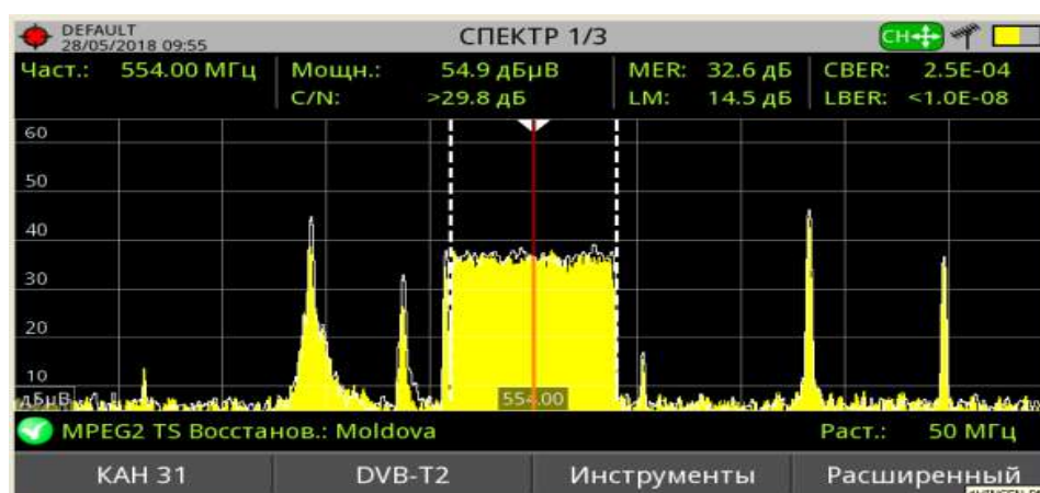
Fig. 3.4. Semnalul la ieșirea feeder-ului antenei R&S HL 040 orientate spre stația Hâncești (stația Hâncești – On, stația Strășeni – On)
