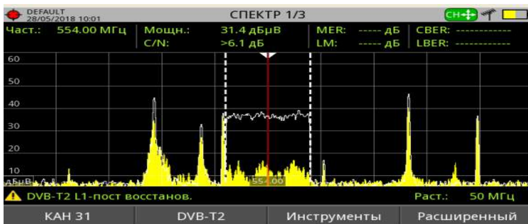
Fig. 3.15. Semnalul la ieșirea feeder-ului antenei R&S HL 040 orientate spre stația Hâncești (stația Hâncești – On, stația Strășeni – Off)
