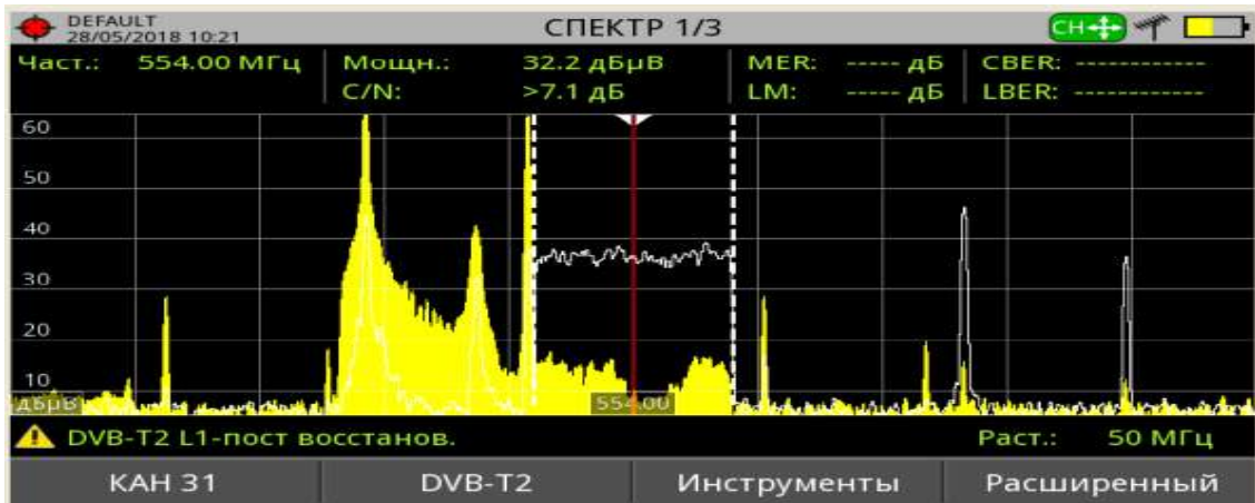
Fig. A7.5. Semnalul la ieșirea feeder-ului antenei R&S HL 040 orientate spre stația Strășeni (stația Strășeni – Off, stația Hâncești – On)
