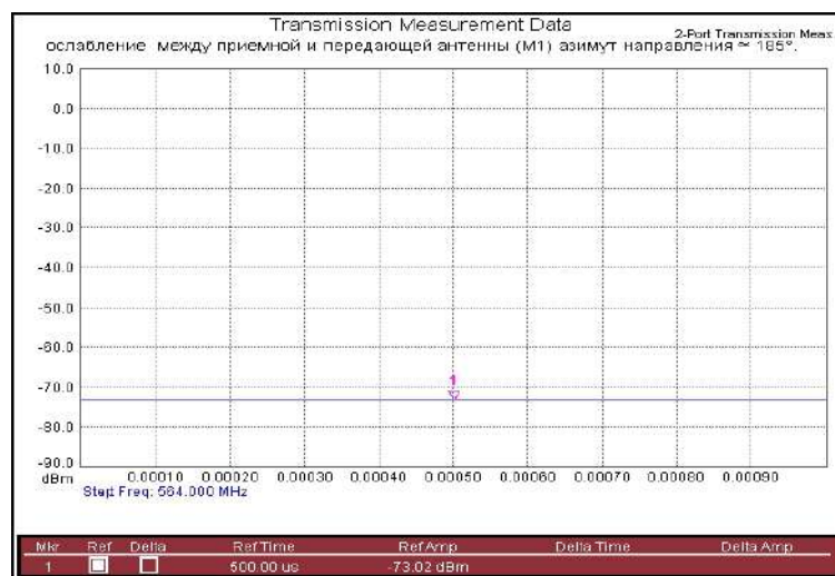
Fig. A4.4. Măsurarea valorii A_{tx-rx} dintre antenele TVA 31/50 și LAP 4 / 5-50 / 16. Unghiul dintre direcțiile de radiație maximă, 55^\circ
