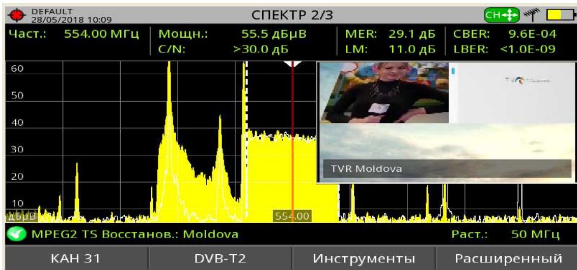
Fig. A7.4. Semnalul la ieșirea feeder-ului antenei R&S HL 040 orientate spre stația Strășeni (stația Strășeni – On, stația Hâncești – Off)
