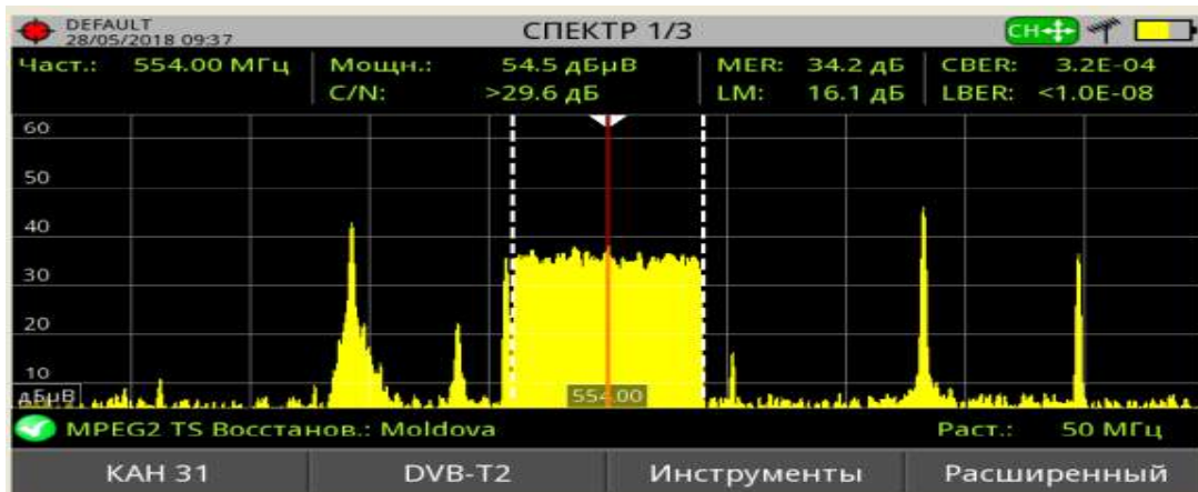
Fig. 3.15. Semnalul la ieșirea feeder-ului antenei R&S HL 040 orientate spre stația Hâncești (stația Hâncești – On, stația Strășeni – Off)
