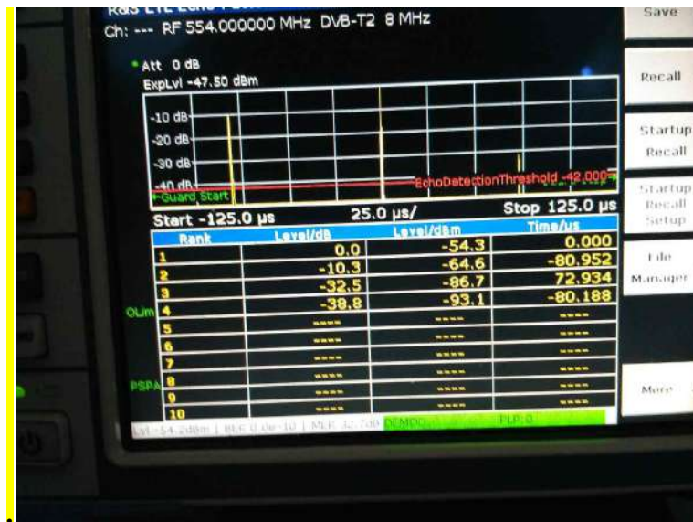
Fig. 2.27. Măsurarea nivelurilor semnalelor de intrare și a timpului de sosire ale acestora
