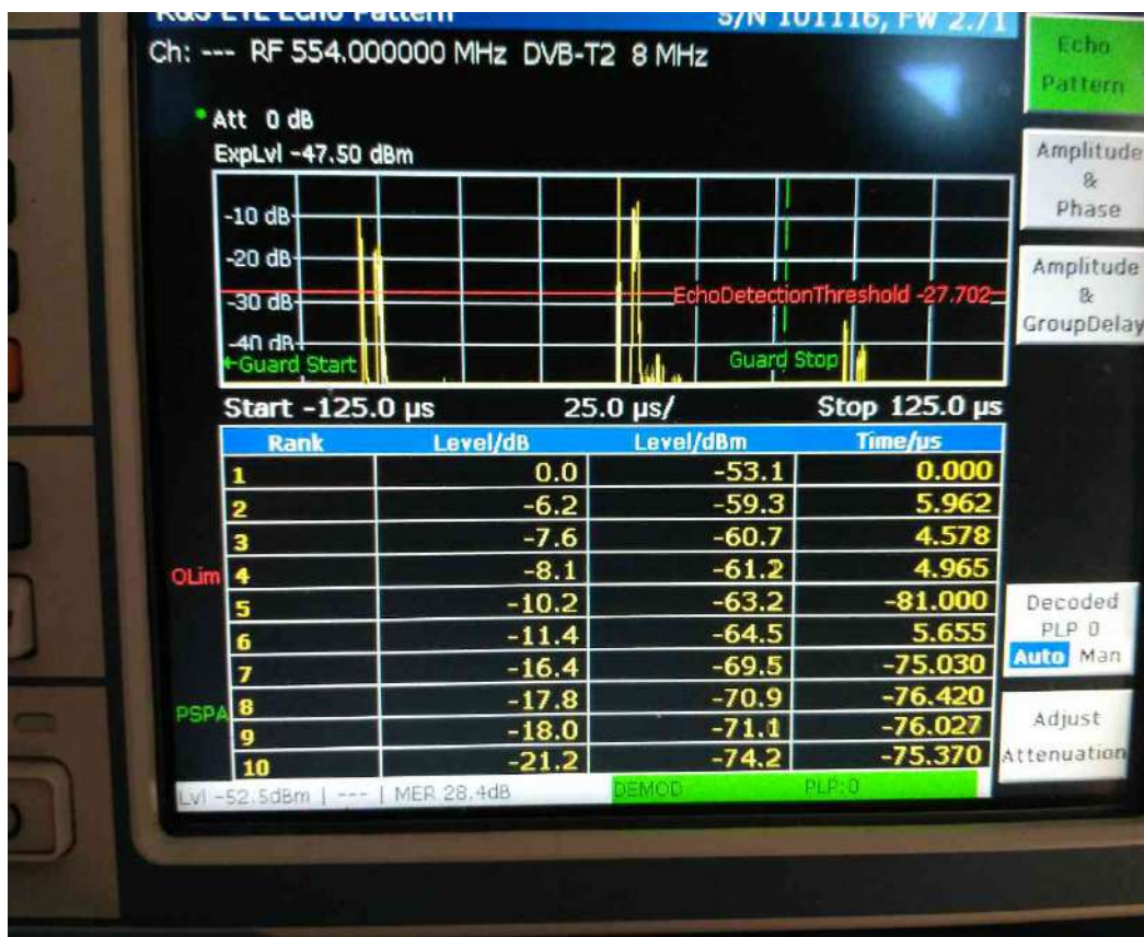
Fig. 2.36. Ecoul propriului semnal la intrarea Gap Filler-ului ( P_{\text{out}} = 75 \text{ mW} ) conectat la antena de emisie TVA 31/50, \Delta\phi = 0^\circ
