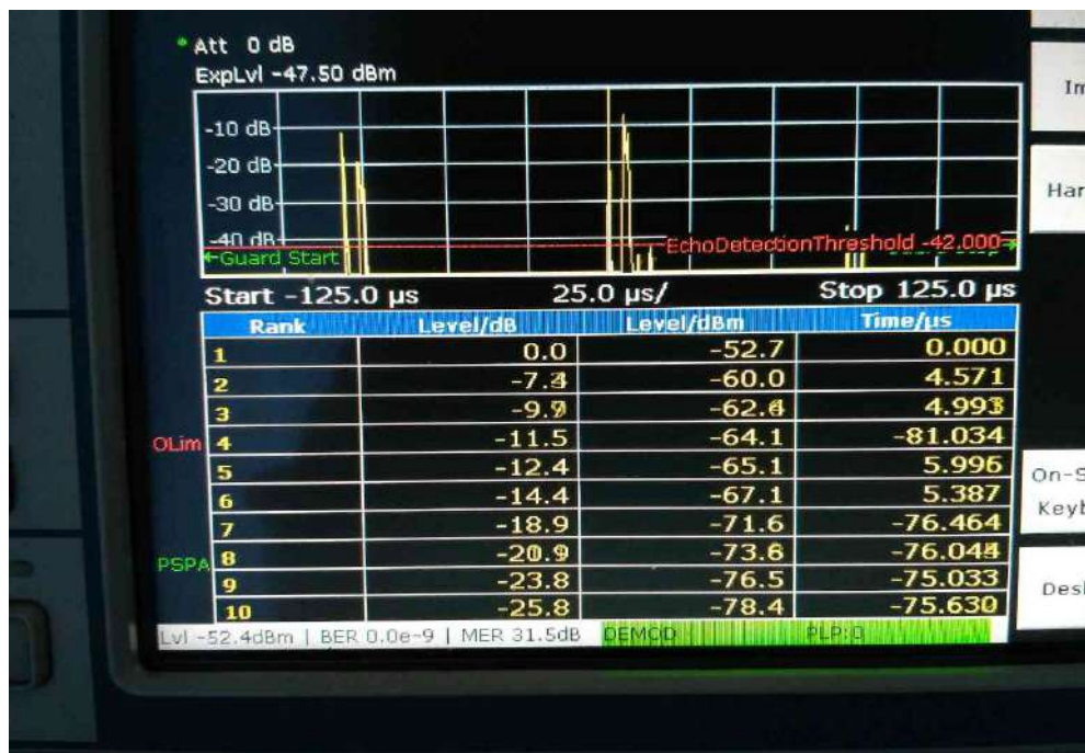
Fig. 2.35. Ecoul propriului semnal la intrarea Gap Filler-ului ( P_{out} = 75 \text{ mW} ) conectat la antena de emisie TVA 31/50, \Delta\varphi = 55^\circ
