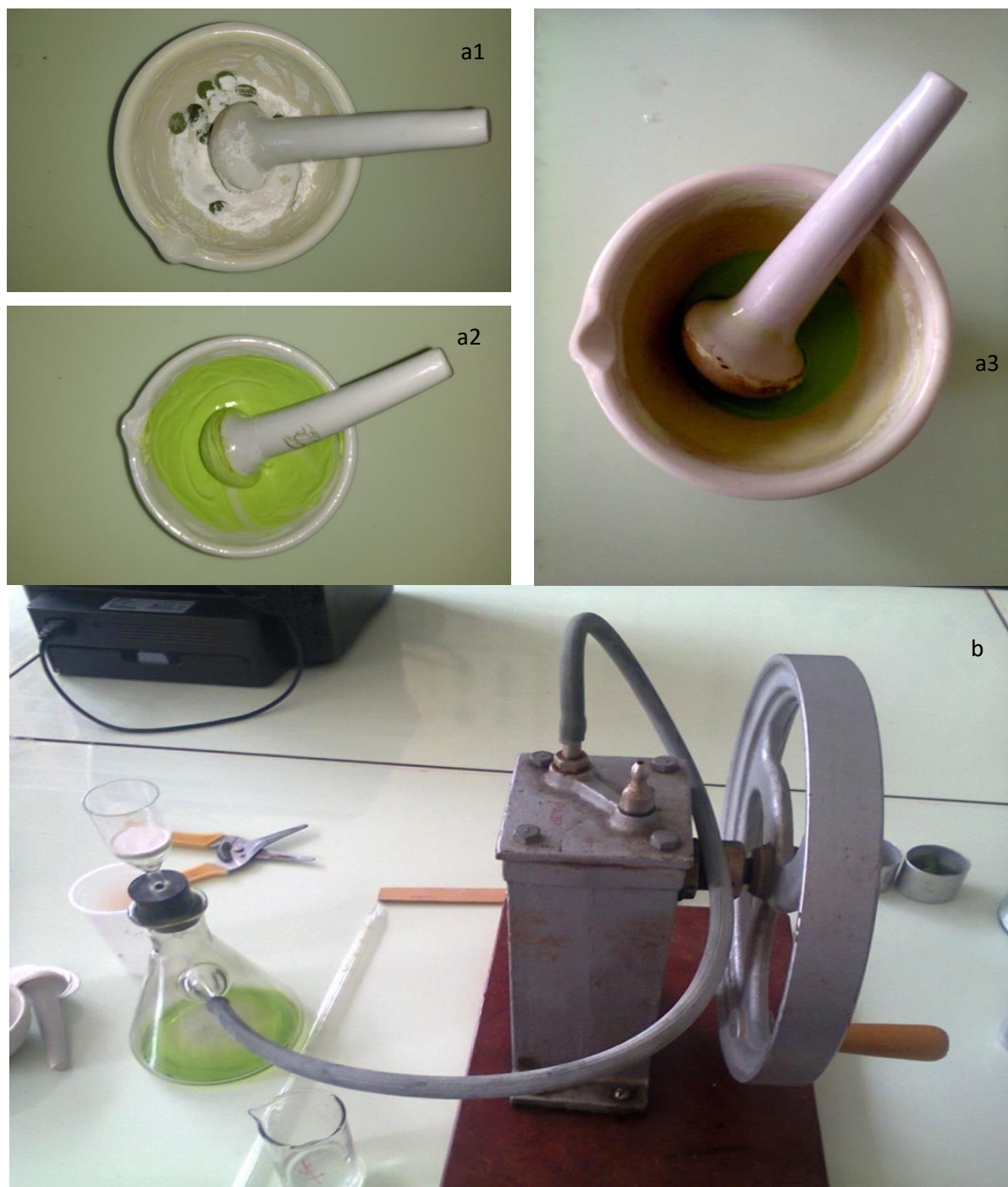
Fig. A 7.2. Determinarea conținutului de pigmenți plastidiali în frunzele soiului Bianca, a1, a2, a3 - măcinarea probei în mojar și obținerea extractului alcoolic de pigmenți, b - filtrarea extractului alcoolic folosind filtru lui Schott și pompă lui Komovsky
