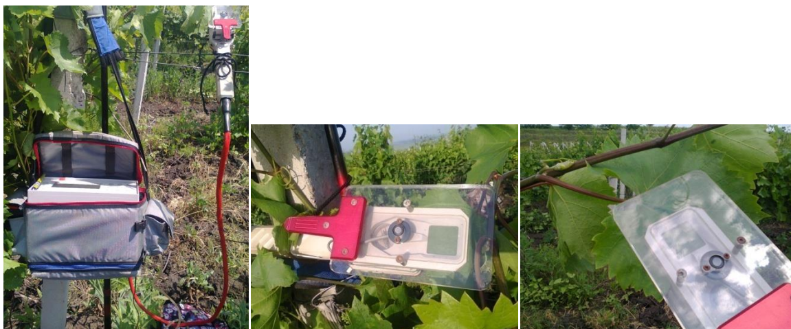
Fig. 4.4. Aspect vizual al analizorului portativ ADC BioScientific Ltd (modelul LCi 4)
