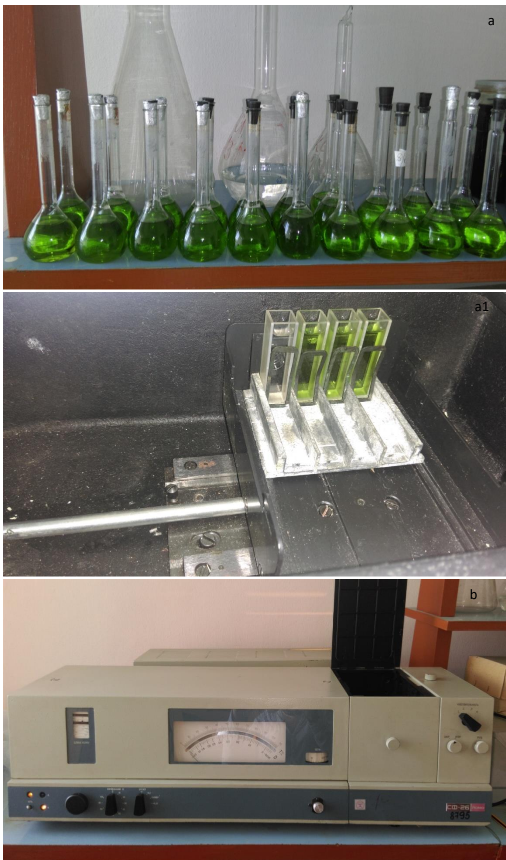
Fig. A 7.3. Determinarea concentrației (conținutul) pigmentilor plastidiali (clorofilei a, b și carotenoizilor): a, a1) cu ajutorul spectrofotometrului CΦ-26, b) aspectul vizual al spectrofotometrului CΦ-26. Sursa: foto autor
