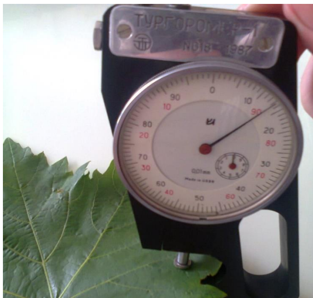
Fig. A 6.1 Determinarea grosimii frunzelor - cu ajutorul micrometrului cadran - turgometrul lui Cușnirenco
