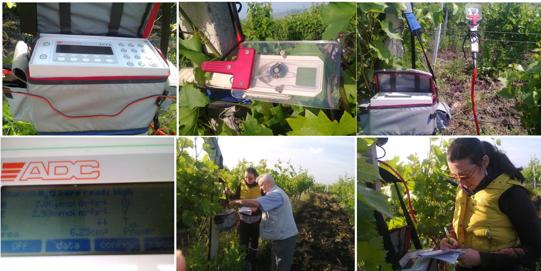
Fig. A 8.1. Aspectul vizual al analizorului de gaze portativ ADC BioScientific Ltd (modelul LCi 4). Cercetări efectuate în câmp Gribcova A.A., dr. hab., prof. Chisili M.F. Sursa: foto autor
