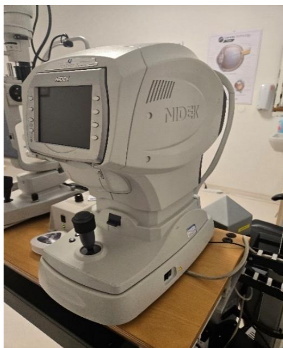
Fig. 2.7. Tono-Kerato-refractometru digital Tonoref II, Nidek, Japonia.
