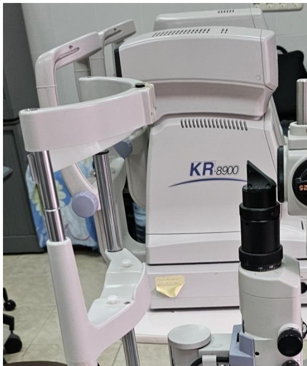
Fig. 2.1. Kerato-refractometrul KR-8900, Topcon, Japonia.
