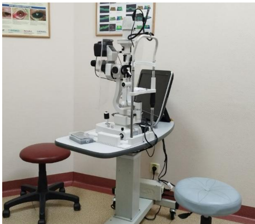
Figura 2.3 Biomicroscopul pentru segmentul anterior și posterior al ochiului cu dispozitiv digital de fotoregistrare.
