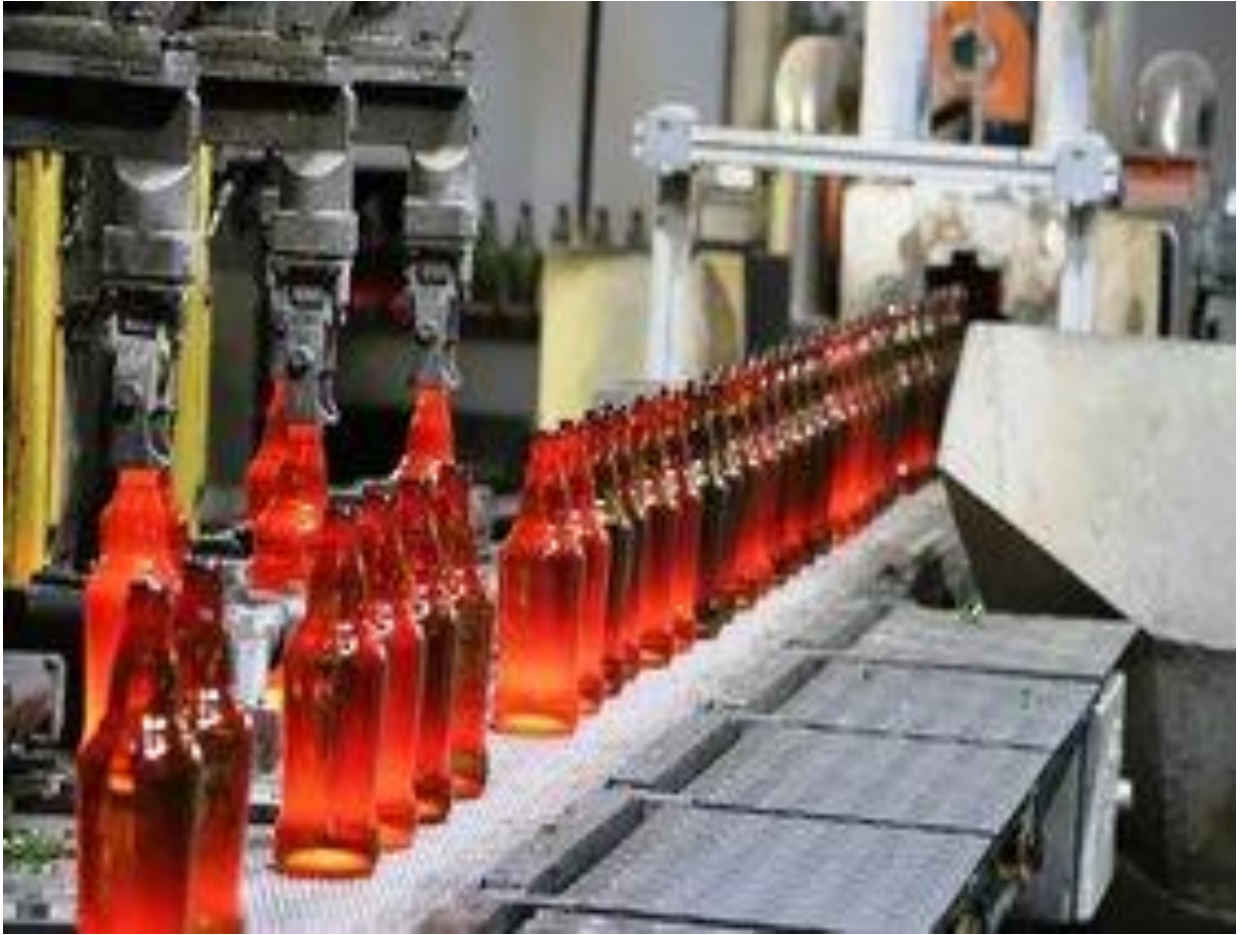
Fig. 3.25. Locul de transportare a buteliilor proaspăt fasonate în cuptorul de recoacere, Fabrica de sticlă din Florești
