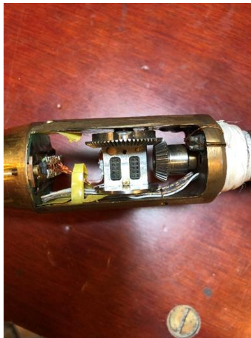
Fig. 2.16. Suport pentru probe care poate fi rotit de la 0° până la 135° în câmp magnetic.
