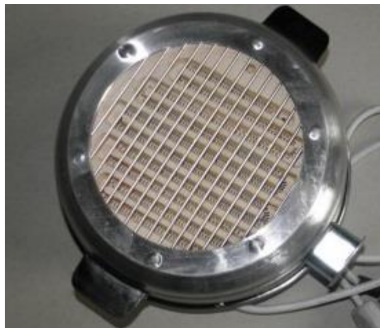
Fig. 2.3. Instalația spinner și instalația de tratare termică a fotorezistului pe probe.
