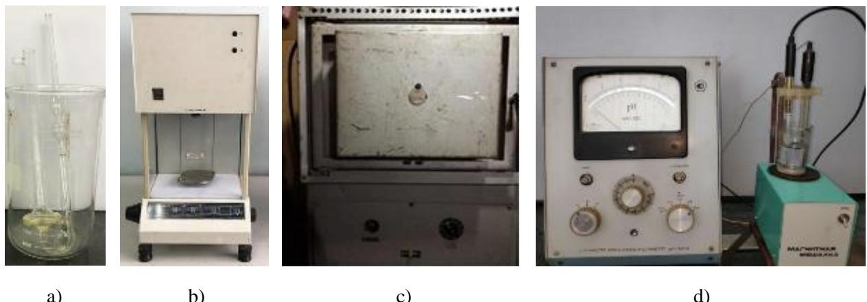
**Fig. 2.3. Echipamente pentru determinarea proprietăților uleiului de motor:**
