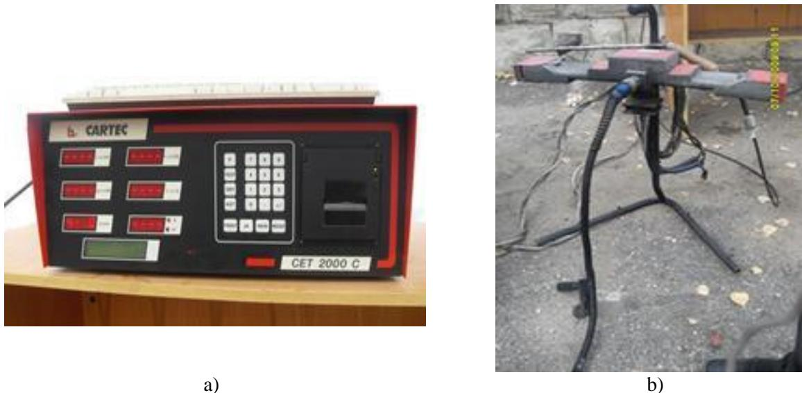
**Fig. 2.6. Analizatorul de gaze Cartec, seria CET 2000:** a) analizatorul de gaze; b) sondă de prelevare a mostrelor gazelor de eșapament
