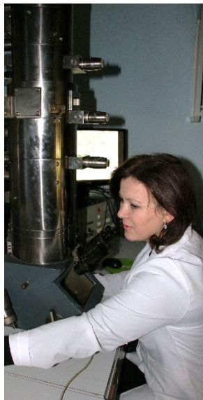
Figura A 37.2 Efectuarea lucrărilor la microscopul electronic Tesla BS 500
